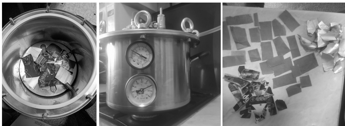
Эксперимент с оптимальным нагревом: закладка, процесс работы, результаты роспуска тетрапака в автоклаве на картон, бумагу и полиалюминиевую смесь (фото)
